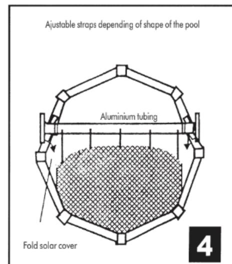
2. Lorsque vous installez les kits de fixation, ils doivent être à égale distance les uns des autres. La longueur des fixations doit être ajustée en fonction de la forme de la piscine.
