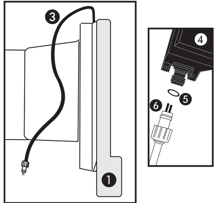
**ÉTAPE 1** Retirer la vis **2** derrière le cache-vis **1** en maintenant le cordon électrique **3** en place.
