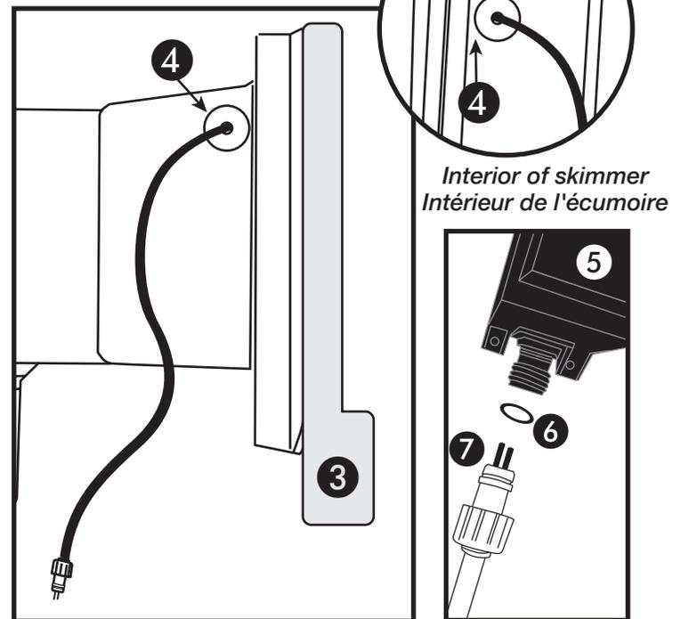
**ÉTAPE 1** Passer le cordon électrique ① au travers le trou pré-percé ② de l'écumoire, tel qu'illustré, laissant juste suffisamment de cordon pour manipuler le cache-vis.
